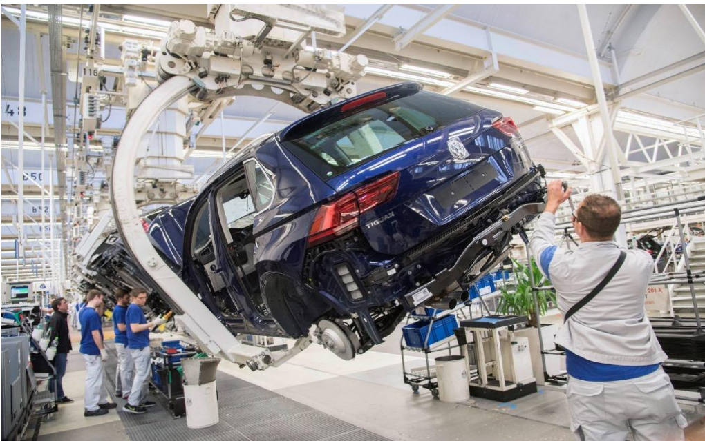
Abbildung: getaktete Fließfertigung beim VW-Golf
